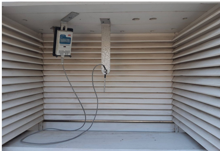
Rys. 6. Miernik temperatury LABEL MR520 (dokumentacja IMGW-PIB).
