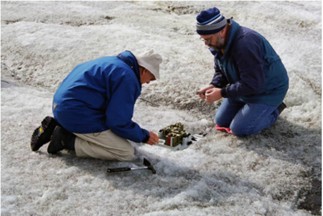
Fot. 7. Rejestracja sejsmicznych zjawisk lodowcowych. Ustawianie sejsmometru rejestrującego fale rotacyjne na powierzchni lodowca. Roman Teisseyre (po lewej), Jerzy Suchcicki (po prawej) (Fot. M. Górski)
